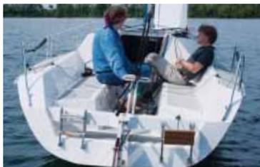
**Cockpit : simple et ergonomique.** Trois adultes peuvent naviguer à l'aise dans ce cockpit où tout est disposé pour faciliter les manœuvres en solo. L'accastillage Harken et Spinlock en série est au niveau de qualité de l'ensemble. Rappelons que sur une unité de cette taille et avec un peu de méthode, les manœuvres, mâtage et mise à l'eau, peuvent également être effectuées par une seule personne. Sur route, avec une remorque adaptée, l'ensemble à tracter est de 1 150 kilos.
