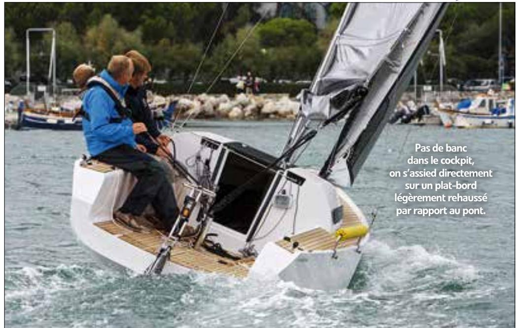
Pas de banc dans le cockpit, on s'assied directement sur un plat-bord légèrement rehaussé par rapport au pont.
